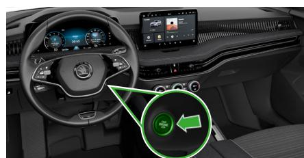
„Engine Start/Stop“ Taste in der Mittelkonsole drücken ohne Fußbremse zu betätigen.
