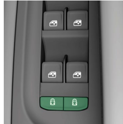
Variante 2: Deaktivierung der elektrischen Kindersicherung über Taste in der Türverkleidung
