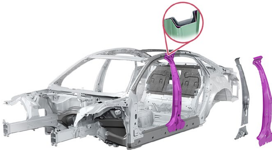
B-Säule mit mehrschaligem Aufbau
