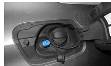
Flüssiggasanschluss am Tankeinfüllstutzen
