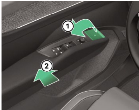
Variante B: Ziehen Sie am Türgriff und öffnen Sie die Tür, z. B. Peaq
