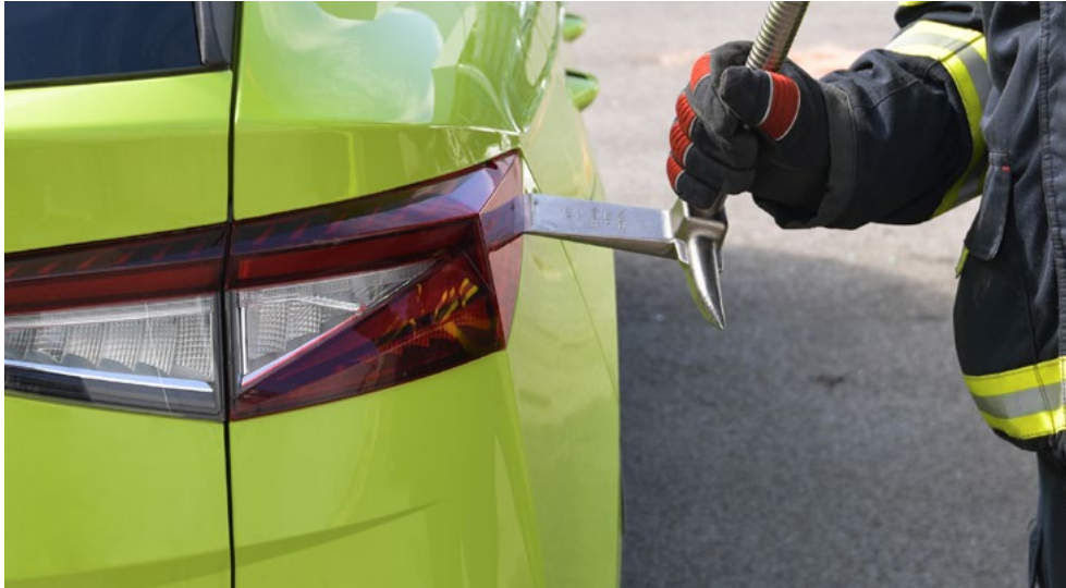
Die Hochvolt-Trennstelle befindet sich bei nach 2023 produzierten Fahrzeugen auch hinter der rechten Rückleuchte
