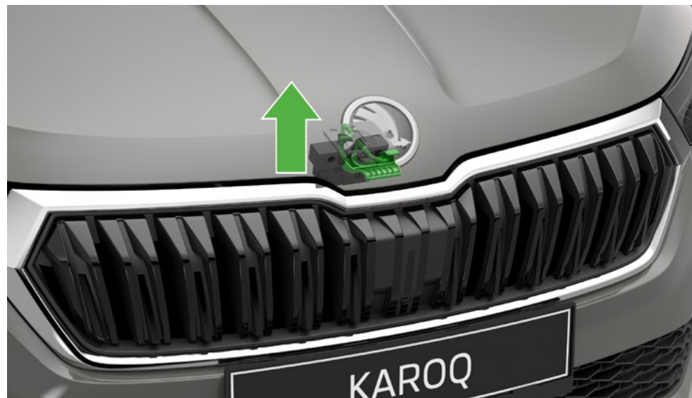
An der Frontklappe: Öffnungshebel (z. B. Karoq)
