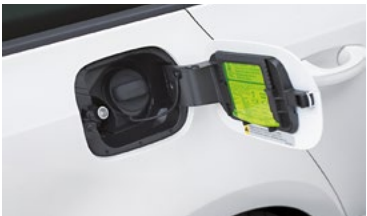
Erdgasanschluss am Tankeinfüllstutzen
