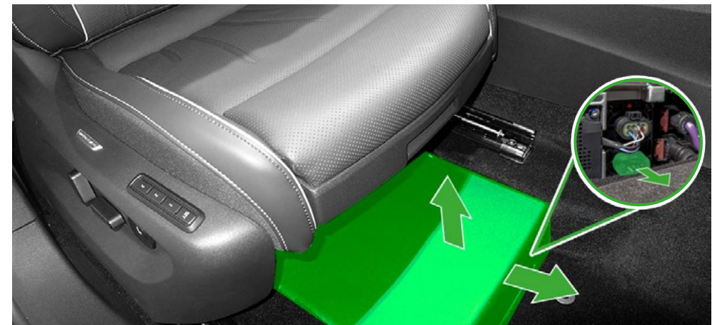
Trennen des 48-V-Systems beim Model Superb ab Baujahr 2023
