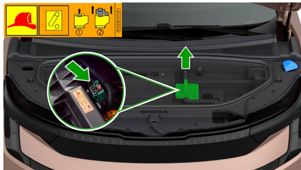
Trennstelle im Vorderwagen des Elektrofahrzeugs Peaq, siehe auch Kennzeichnung für ab 2023 produzierte Modelle
