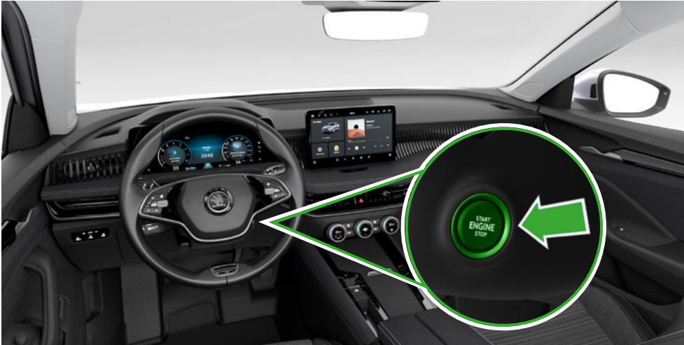
„START-ENGINE-STOP“-Taste an der Lenksäule
