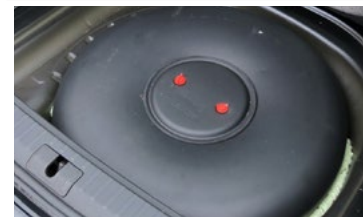
Autogas- bzw. Flüssiggastank im Gepäckraumboden
