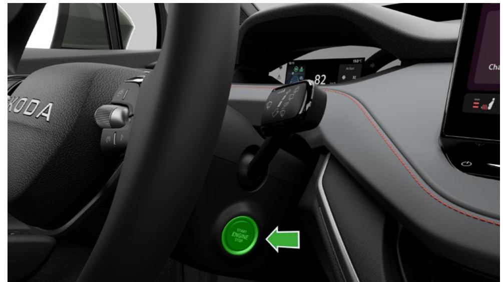
Ausschalten des Fahrzeugs mit dem Kessy-System
