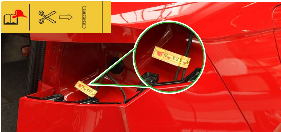
Rettungstrennstelle unter dem Rücklicht, siehe auch Kennzeichnung für ab 2023 produzierte Modelle
