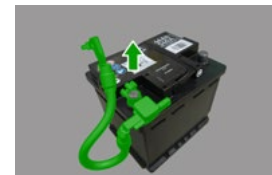
Trennen der 12-V-Batterie (z. B. Peaq)
