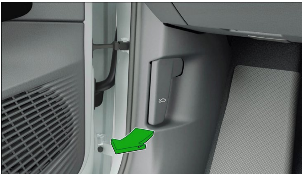
Im Fußraum auf der Fahrerseite: Hebel zur Entriegelung der Frontklappe
