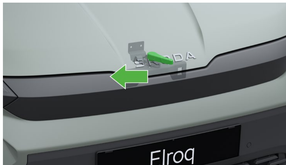
An der Frontklappe: Öffnungshebel (z. B. Elroq)
