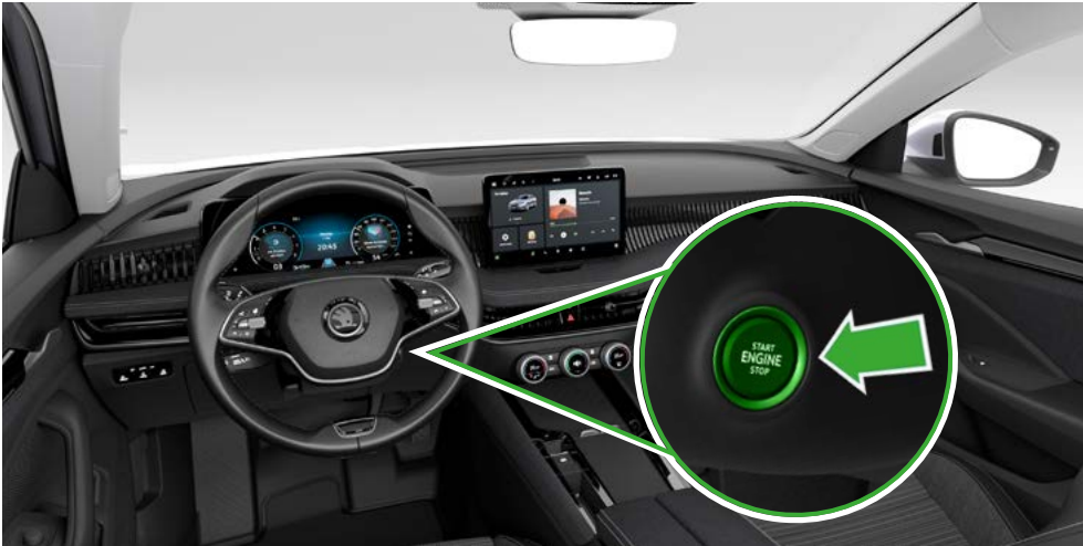
Pulsante "START-ENGINE-STOP" sulla colonna dello sterzo
