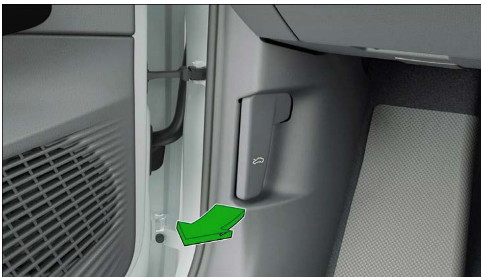
Nel vano piedi lato conducente: leva di apertura del cofano
