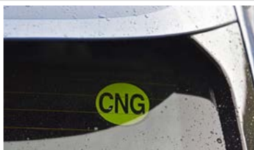
Etichetta nell'angolo in alto a destra del lunotto posteriore
