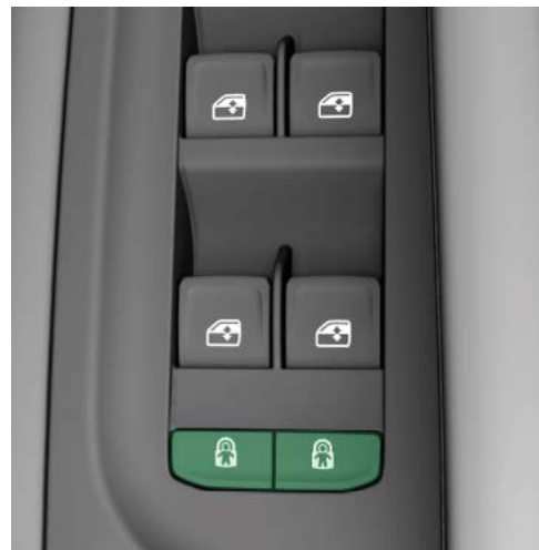
Variante 2: Disattivazione del blocco di sicurezza elettrico utilizzando il pulsante nel rivestimento della porta
