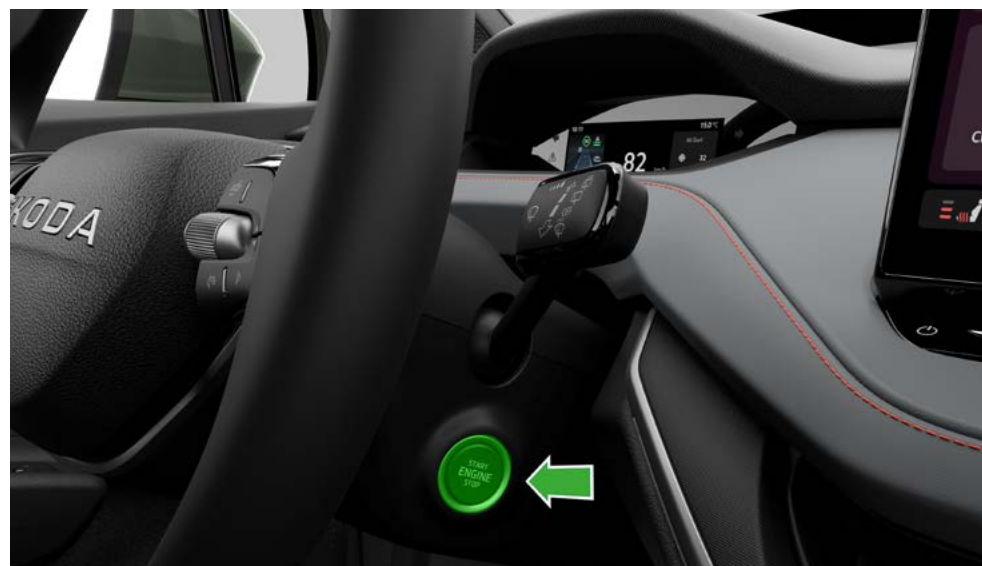
Spegnimento del veicolo con il sistema Kessy
