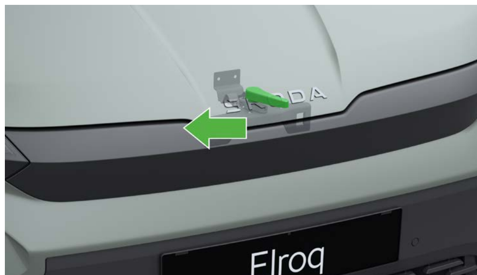
Sul cofano: rilascio della chiusura (ad esempio Enyaq)
