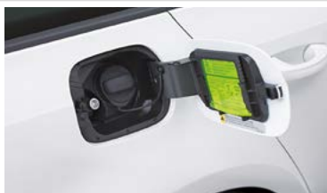
Collegamento per gas naturale presso il bocchettone di rifornimento
