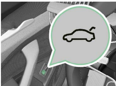
Pulsante nel rivestimento della porta lato conducente
