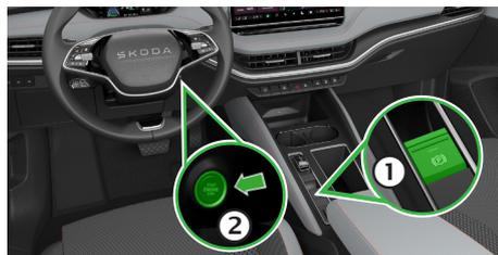
1. Accione el freno de estacionamiento electrónico.
