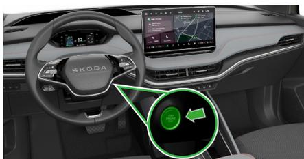
Pulse el botón «Engine Start/Stop» de la columna de dirección sin pisar el freno de pie.
