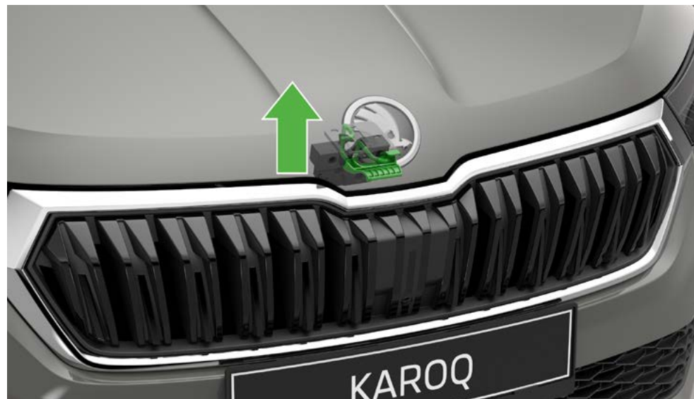
U kapoty: odjištění zámku (např. Karoq)
