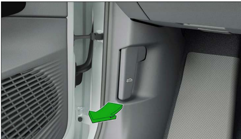
V podlaze u řidiče: páka pro uvolnění kapoty.
