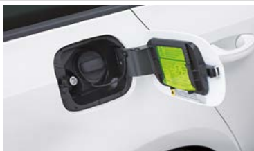
Přípojka zemního plynu na plnicím hrdle
