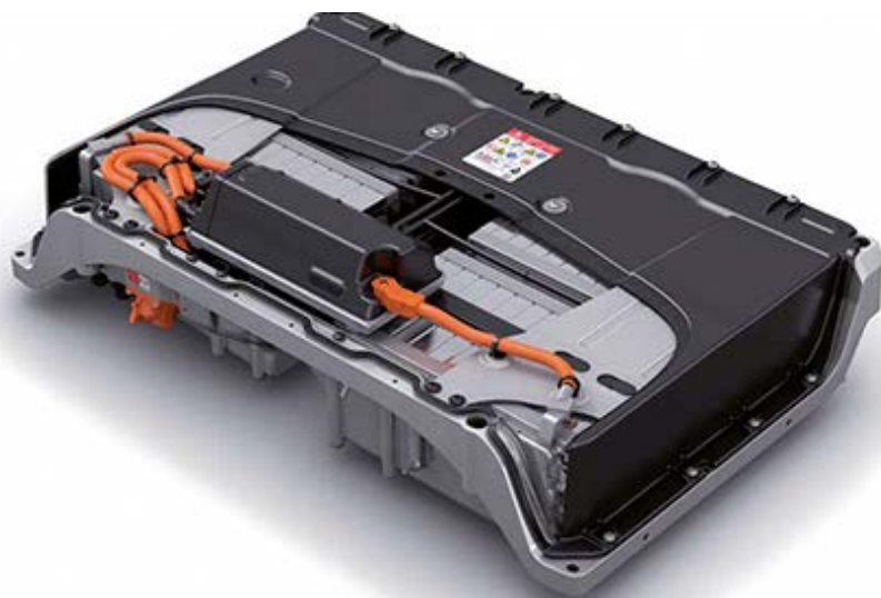
Vysokonapěťová baterie vozu Superb iV
