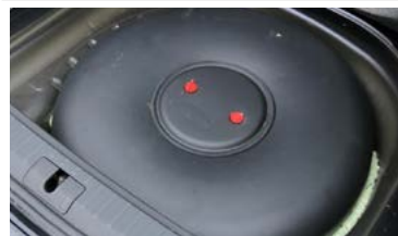
Nádrž na LPG na dně zavazadlového prostoru
