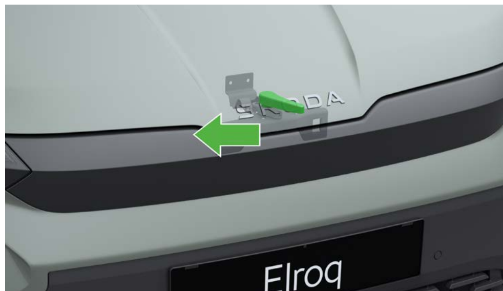
U kapoty: odjištění zámku (např. Enyaq)
