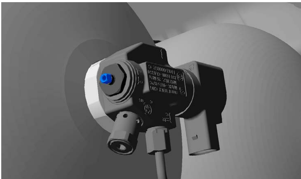
Uzavírací ventil otáčejte plochým klíčem velikosti 5 mm, kleštěmi nebo speciálním nástrojem ve směru hodinových ručiček až do krajní polohy
