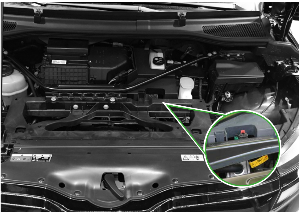
Bod pro odpojení v přední části elektrického vozu, viz také Nové označení pro modely vyrobené po roce 2023
