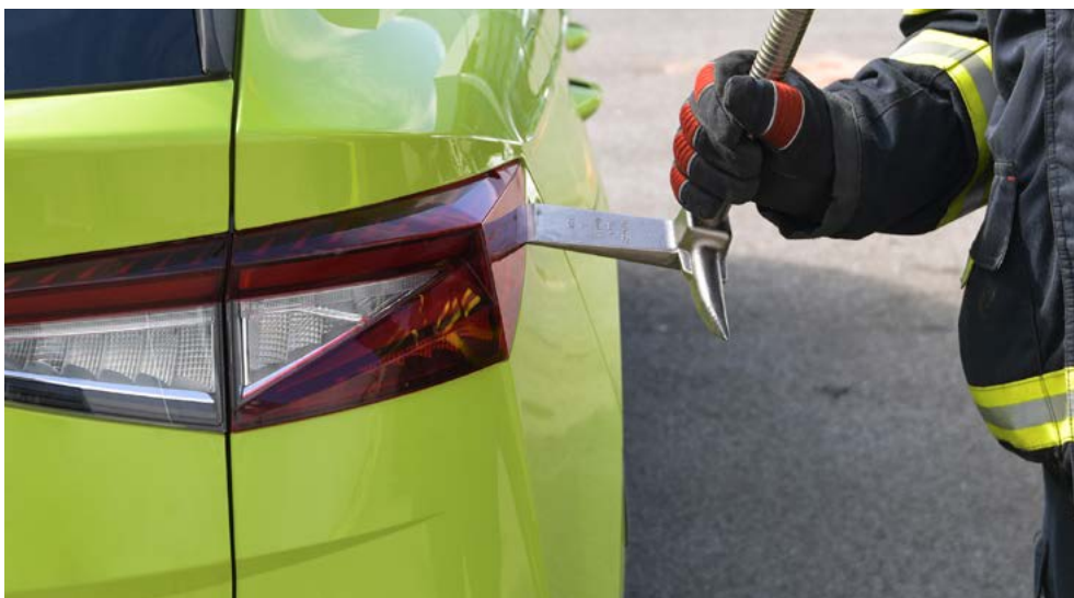
Odpojení vysokého napětí je u vozů vyráběných od roku 2023 také za pravým zadním světlem
