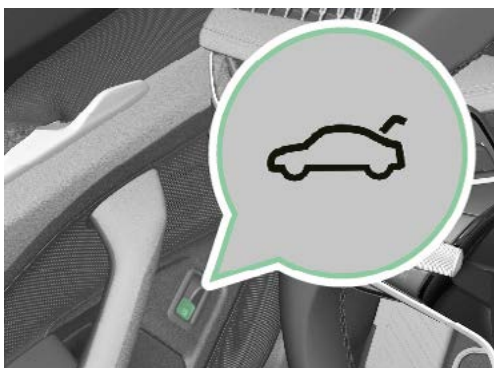
Tlačítko v obložení dveří na straně řidiče
