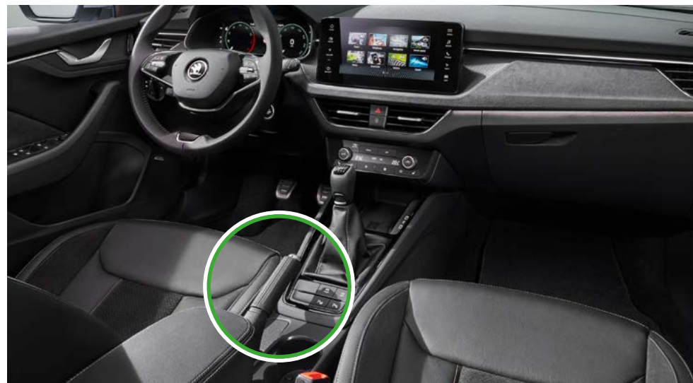
Vůz s manuální převodovkou a manuální ruční brzdou.
