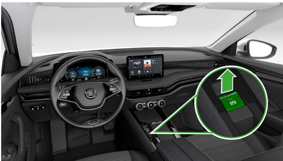
Vůz s konvenčním motorem a automatickou převodovkou: Použijte elektrickou parkovací brzdu nebo zatáhněte za páku ruční brzdy
