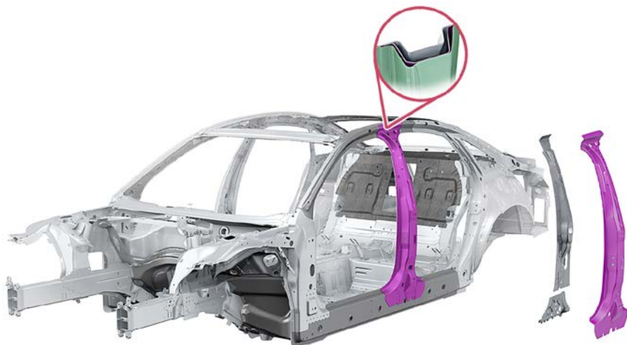
Sloupek B s vícevrstvou strukturou
