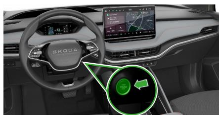
Apăsați tasta „Engine Start/Stop” (Pornire/Oprire motor) de pe coloana de direcție, fără să apăsați pedala de frână.
