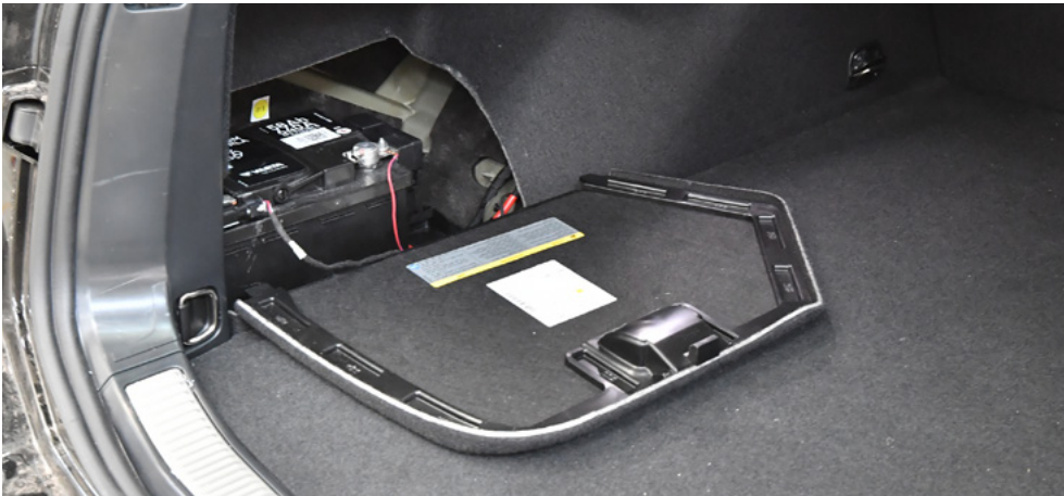
Emplacement de montage dans le coffre à bagages (par exemple Superb)
