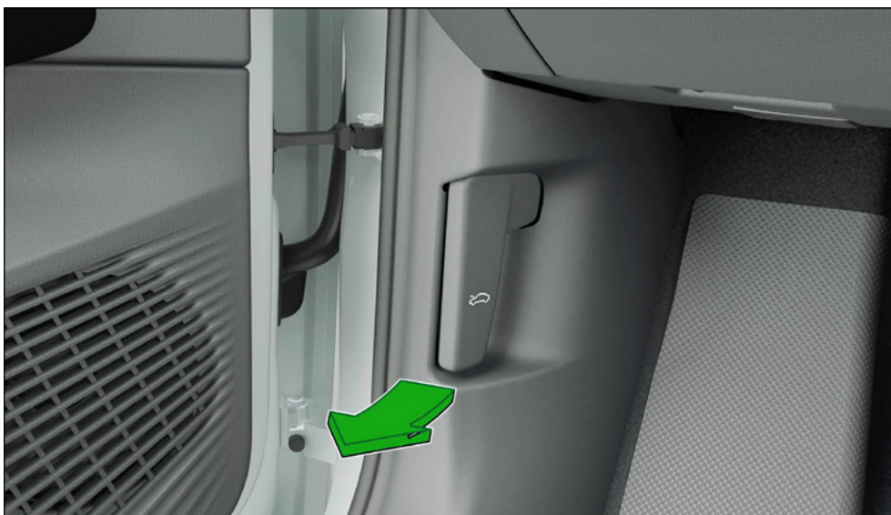
Dans le plancher côté conducteur : levier d'ouverture du capot avant
