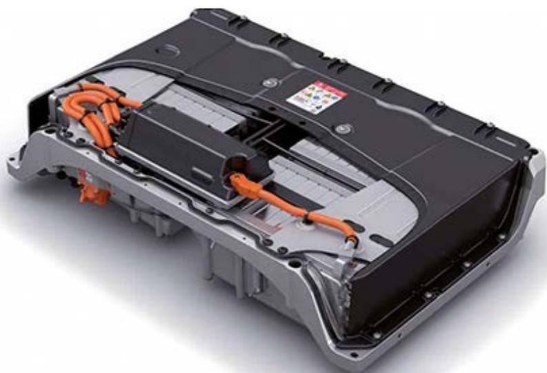
La batterie haute tension du véhicule Superb iV
