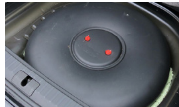
Réservoir de GPL dans le plancher du coffre à bagage
