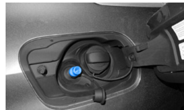
Prise sur la goulotte de remplissage de carburant
