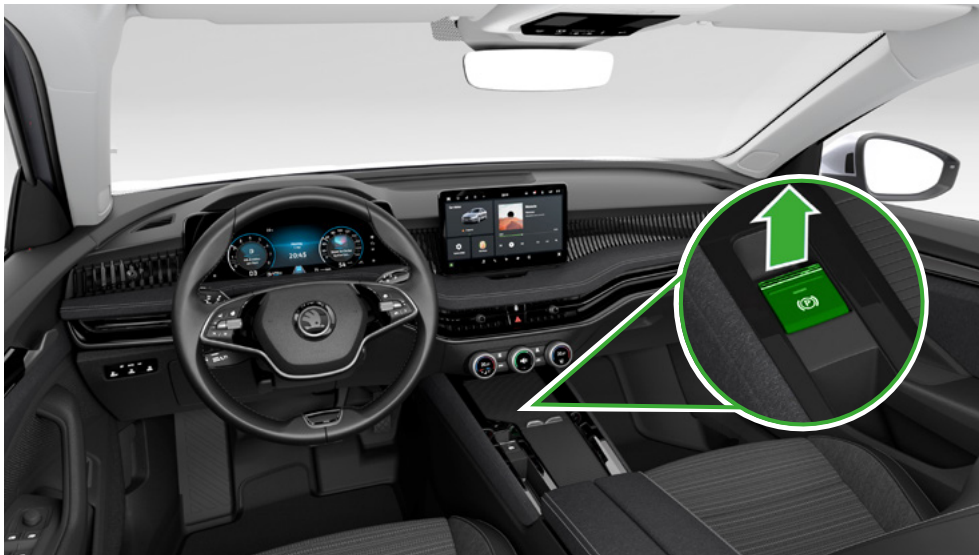
Véhicule avec moteur conventionnel et boîte de vitesses automatique : actionner le frein de stationnement électrique ou tirer le frein à main manuel
