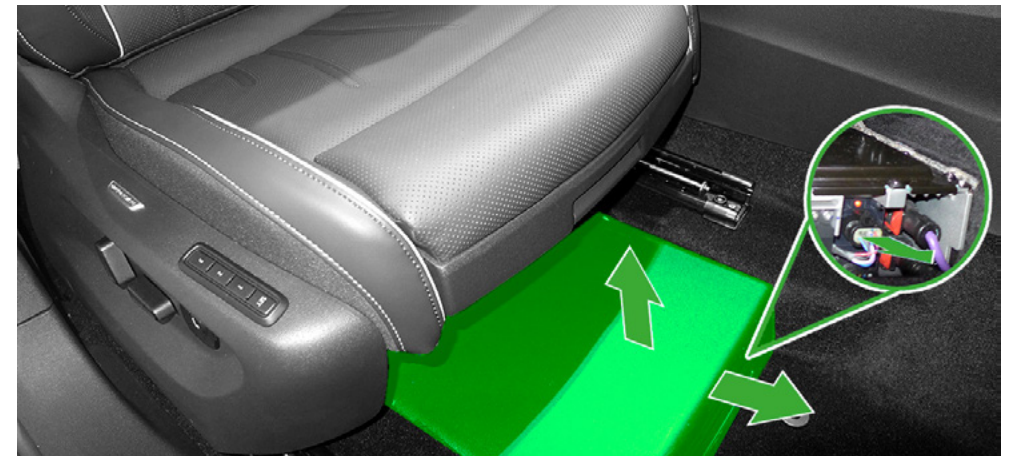
Débrancher le réseau de bord 48 V sur le modèle Superb à partir de 2023
