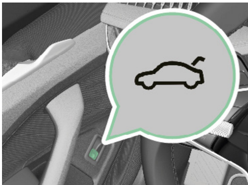
Touche dans le revêtement de porte au niveau du conducteur
