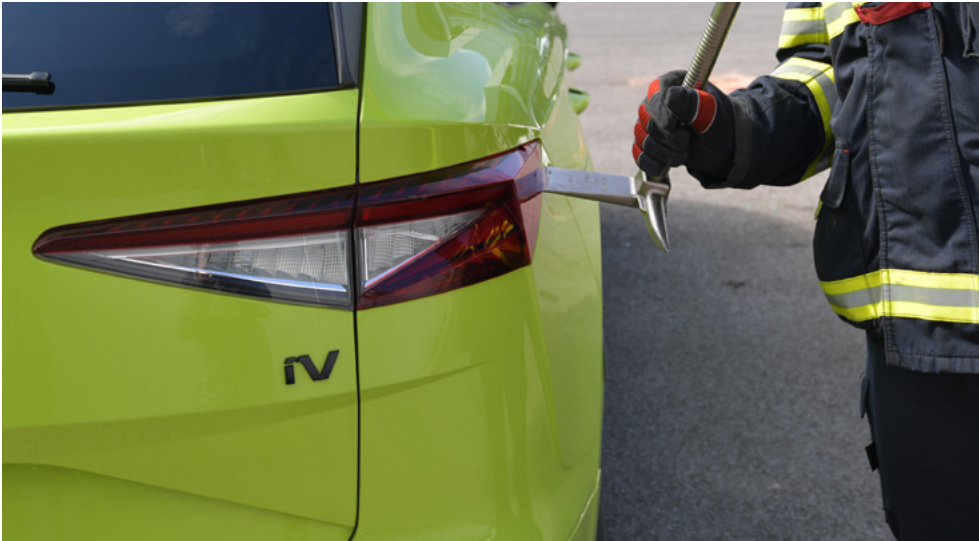
Point de coupure du réseau haute tension derrière le bloc de feux arrière droit pour les véhicules produits à partir de 2023
