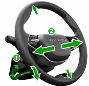
Réglage mécanique de la colonne de direction
