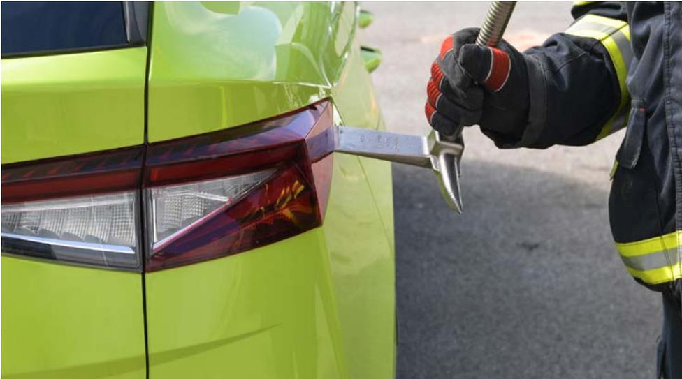
Point de coupe du réseau haute tension derrière le bloc de feux arrière droit pour les véhicules produits à partir de 2023
