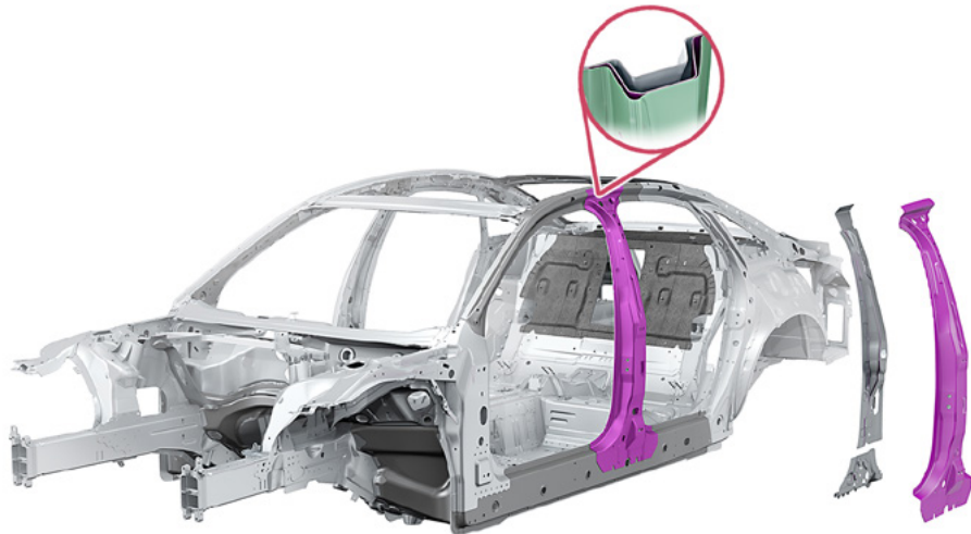
Montant B avec structure multicouche
