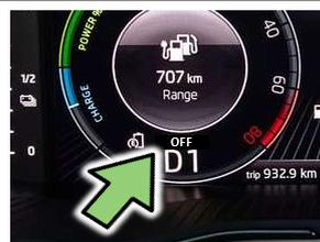
Der Elektromotor ist geräuschlos. Das Display im Kombi (Powermeter) zeigt an, ob der elektrische Antrieb ausgeschaltet "OFF" oder betriebsbereit ist "READY".
