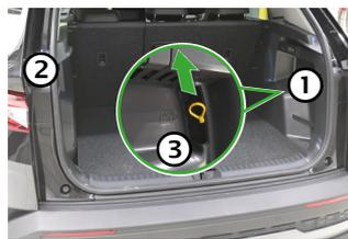
1. Abra la tapa perforada del panel lateral derecho.
