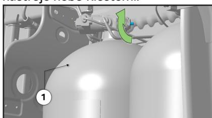
Uzavřít ventil plynové nádrže č.2 ve směru šipky pomocí vhodného nástroje nebo kleštěmi.
