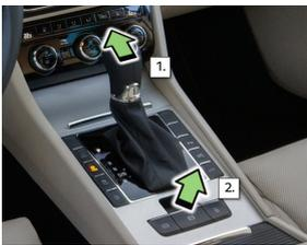
1. Colocar la palanca selectora en la posición "P".
