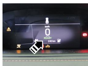
El motor eléctrico es silencioso. El cuadro de instrumentos muestra un mensaje que le indica si el motor eléctrico está apagado "OFF" o listo para su uso "READY".
