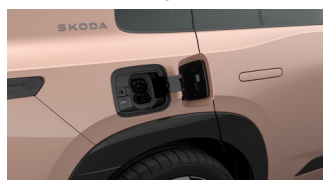
Prise de recharge
