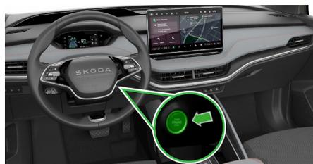
Premere il tasto "Engine Start/Stop" sul piantone dello sterzo senza azionare il pedale del freno.
