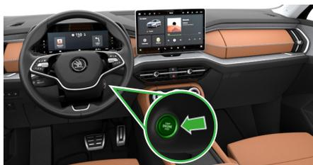
Premir a tecla "Engine Start/Stop" na coluna da direção sem acionar o pedal do travão.
