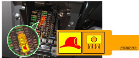
Separar da rede de bordo a bateria da rede de bordo de 12 V no porta-malas atrás, à esquerda, utilizando uma ferramenta adequada.
