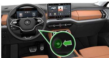
Appuyez sur le bouton Engine Start/Stop dans la colonne de direction sans appuyer sur la pédale de frein.
