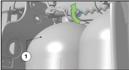
Ventil am Gastank Nr.2 in Pfeilrichtung mit geeignetem Werkzeug oder einer Zange schließen.
