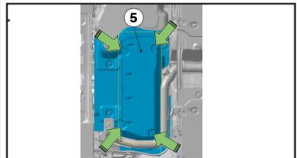
Ventil am Gastank Nr.1 in Pfeilrichtung mit geeignetem Werkzeug oder einer Zange schließen.
