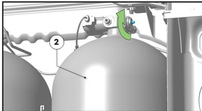
Ventil am Gastank Nr.3 in Pfeilrichtung mit geeignetem Werkzeug oder einer Zange schließen.
