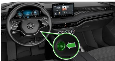
Appuyer sur le bouton « Engine Start/Stop » de la console centrale sans actionner la pédale de frein.
