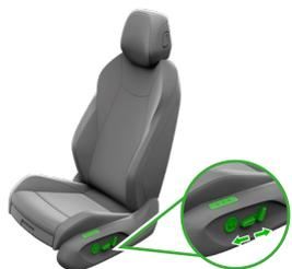
Réglage mécanique du siège
